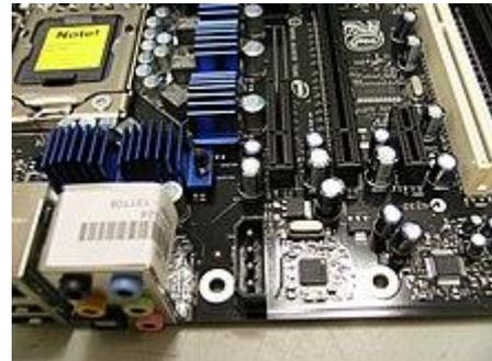
El zócalo (socket) de CPU es un receptáculo que encastra el microprocesador y lo conecta con el resto de componentes a través del bus frontal de la placa base.
